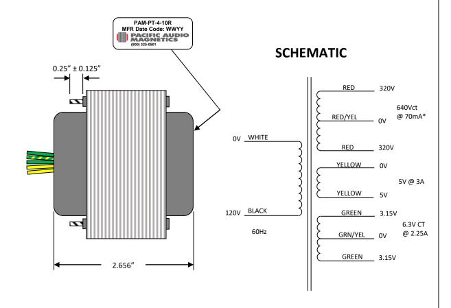
\*Vct (no-load): 345V – 0V – 345V Vct (simulated): 320V – 0V – 320V
