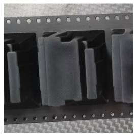
变更后: 载带进行铆接, 有铜箔接头;
