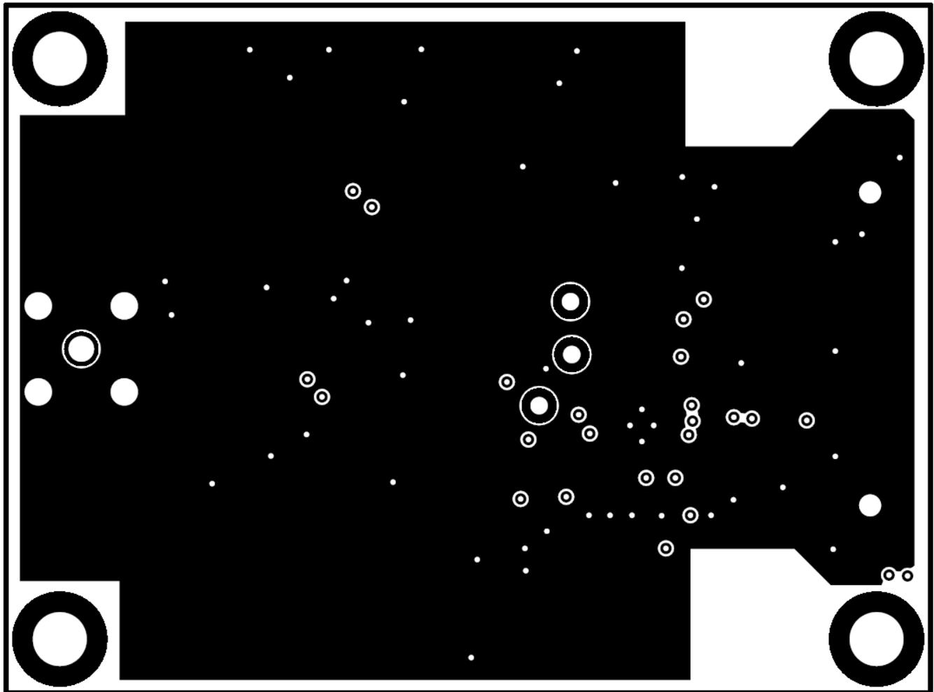
Figure 15. ADS7049-Q1EVM PCB Layer 2: GND Plane
